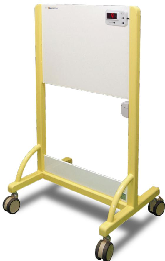
弊社製自動投与装置UG-01は大量の「FDGスキャン注」を使用する施設において、投与における従事者の被曝低減に効果を発揮しております。本遮蔽衝立はUG-01専用の遮蔽衝立です。UG-01使用時は、従事者と被験者はUG-01本体を介して対峙する姿勢をとりますが、本遮蔽衝立をUG-01と併せて使用することで、FDG溶液の投与中および投与後の被験者からの被曝をさらに低減させることができます。また、本衝立には積算型放射能通過センサーが装備されており、FDGが確実にチューブを通過し、被験者に到達していることが判断できますので、投与時には表示板を遠隔で監視することによって一層の被曝低減が期待できます。
